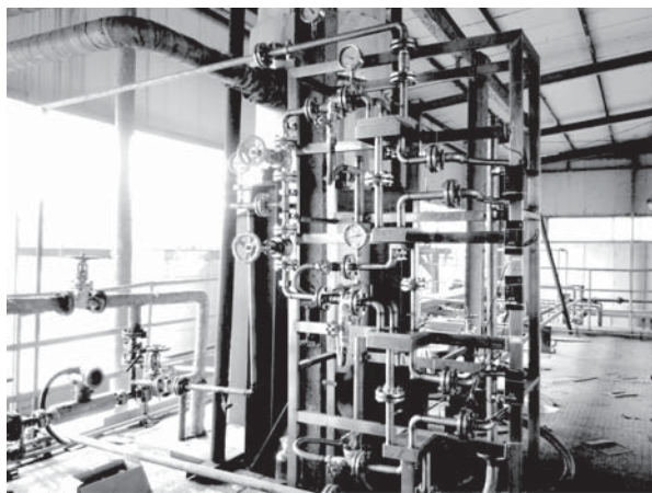
图3 万吨规模石油磺酸盐生产示范运行的微反应系统
