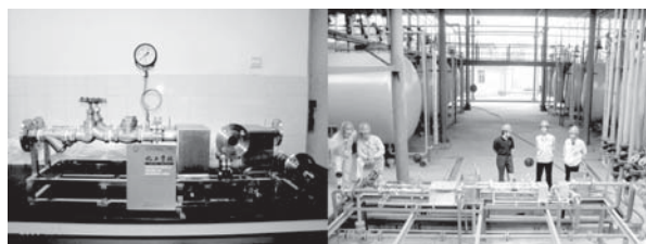
图2 微反应系统工业应用(8万吨/年磷酸二氢铵)
