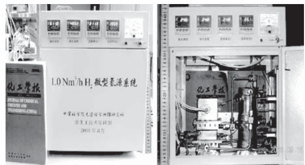
图1 1\text{Nm}^3/\text{h} 的微型氢源系统实物图
